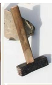
*Boucharde : marteau à deux têtes carrées couvertes pointes diamant. Sert à donner un aspect granuleux aux faces lisses des pierres. Elle apparaît fin 18ème.*
