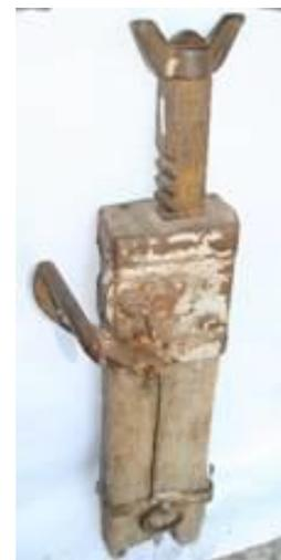
*Cric à crémaillère : permet de soulever, de lever, de déplacer les blocs. Le principe du cric à crémaillère était déjà connu dans la Grèce Antique. Sa hauteur est d'environ 60 cm*
