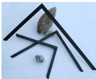
*Equerres : utilisées pour les angles et l'équerrage des blocs de pierre taillée*
